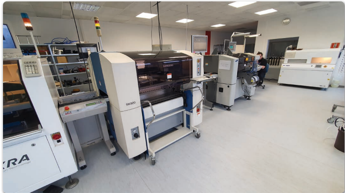
Die Fertigung von Elec-Con ist hochflexibel – mit zwei SMD-Automaten, Dampfphase sowie Lötwellen. Ausgelegt ist sie für Muster und Kleinserien, die auch mehr als hundert SMD-Positionen enthalten können
