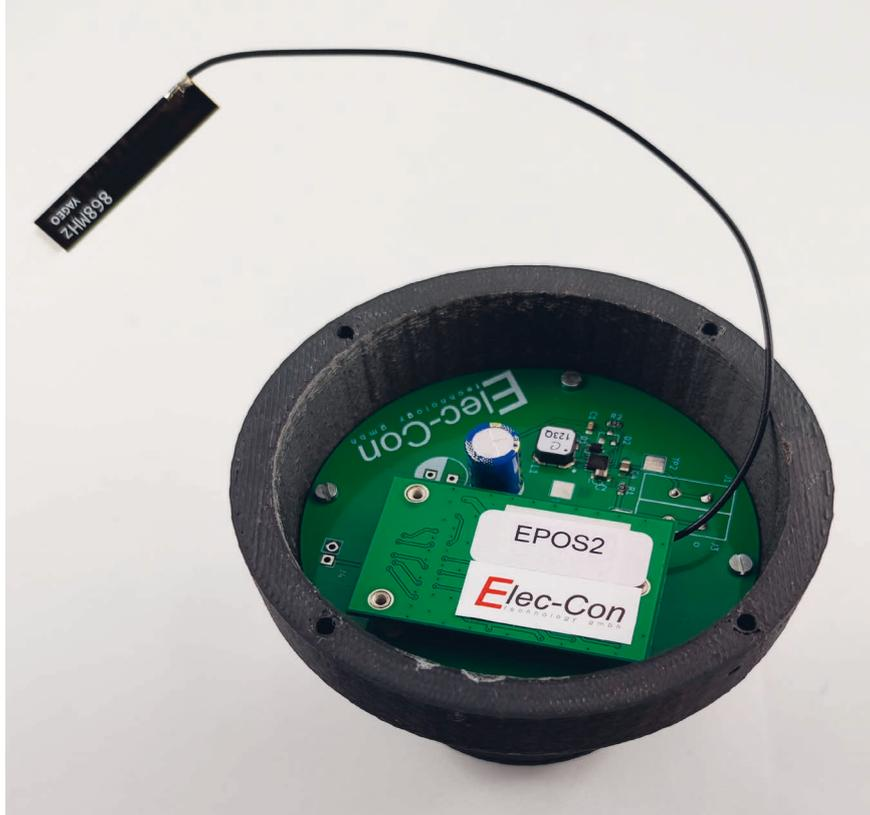
**Die gesamte Elektronik des IoT-Moduls findet Platz in einem tassengroßen Gehäuse. Der Energiewandler befindet sich unterhalb der Elektronik. Die externe Antenne des SigFox-Funkmoduls kann so platziert werden, dass bei minimaler Sendeleistung maximale Reichweite erzielt wird.**
